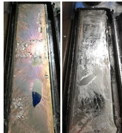
Abb. 2: Lotbadoberfläche ohne/mit Additiv, weniger Krätze, weniger Brücken
